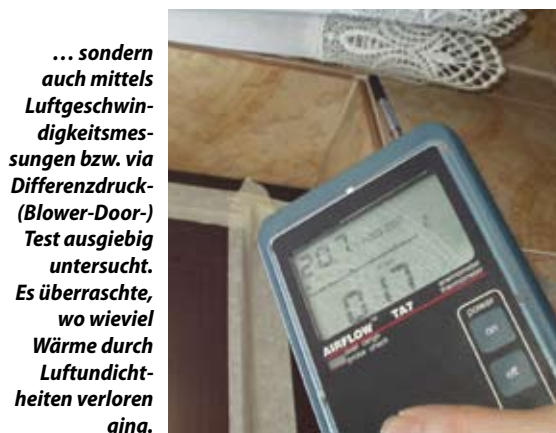
Vor dem eigentlichen Renovierungsstart wurde das Haus umfassend analysiert – das Objekt wurde nicht nur mittels Wärmebildkamera thermografiert ...
